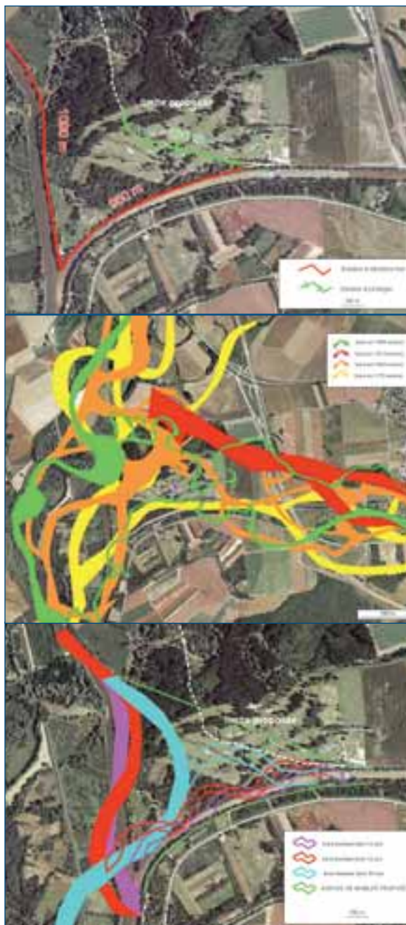
Figure 49 : Exemple d'analyse prédictive du tracé de deux cours d'eau à leur confluence suite à la suppression des contraintes latérales. En haut, contexte local des protections existantes et de leur report en arrière pour protéger un golf existant mais qui sera en partie déplacé. Au centre, analyse historique des tracés. En bas, simulation du tracé à 10 et 50 ans (source : Malavoi, 2005). ≈
