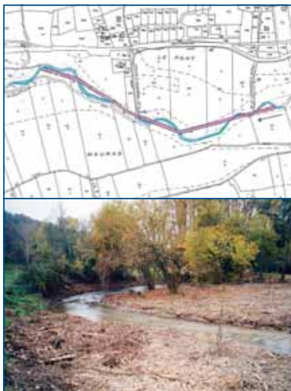
↑ Figure 99 : En haut, localisation. En bas, méandre remis en eau. ≍
