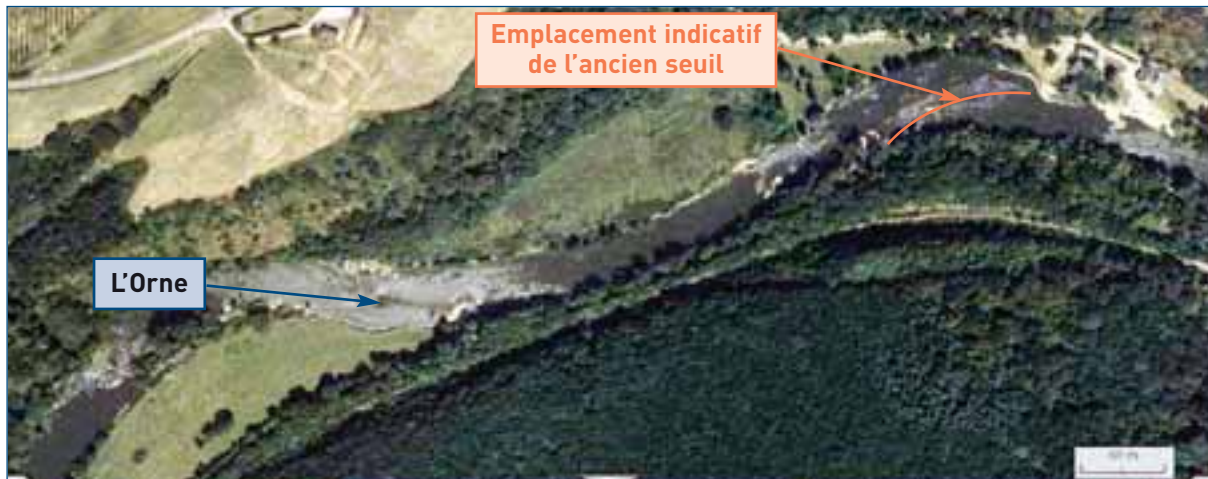
↑ Figure 46 : Photo aérienne (datant de fin juin 2002) montrant le secteur de l'Orne restauré suite à l'arasement du seuil du Moulin de Viard (source : Arnaud Richard, CSP (aujourd'hui ONEMA), délégation régionale Bretagne/Basse-Normandie). ≍
