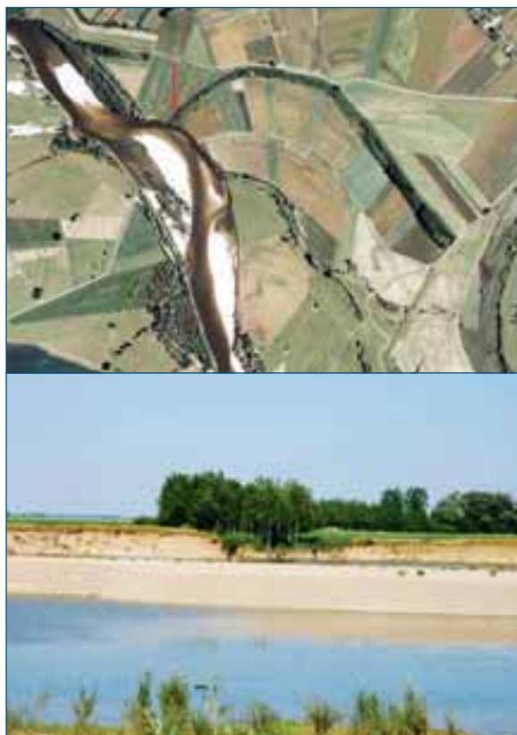
↑ Figure 30 : Exemple d'annexe déconnectée sur cours d'eau incisé. Le fond de l'annexe (vue de face sur la photo) est perché à plus d'1m du niveau moyen des eaux. ≍
