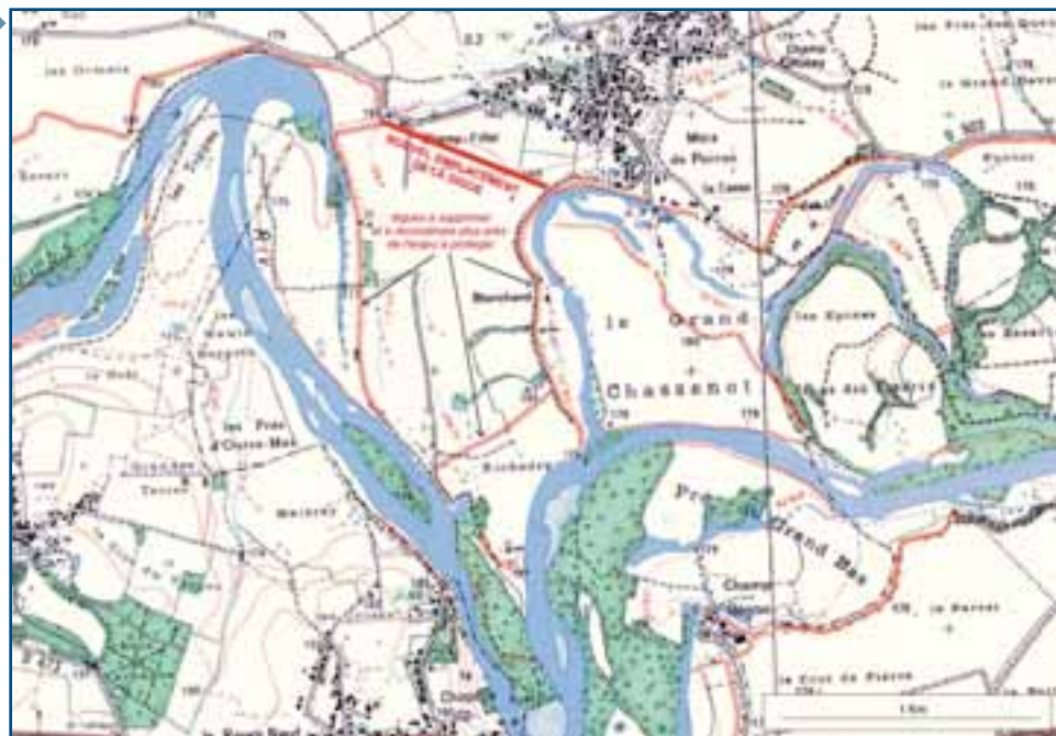
➔ Figure 79 : Exemple de réseau de digue pouvant être modifié pour conserver le même niveau de protection de l'enjeu principal (le village). On perdra par contre la protection des terrains agricoles actuellement peu submersibles mais on gagnera, outre une meilleure fonctionnalité écologique, un meilleur écrêtement des crues pour l'aval (source : Malavoi, Safège, 2004). ≍
