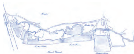
Plan de la Morinière en 2005, extension des zones inondées par infiltration de l'eau dans les sablières
