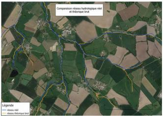
Illustration 9: Réseau hydro réel VS réseau théorique brut
