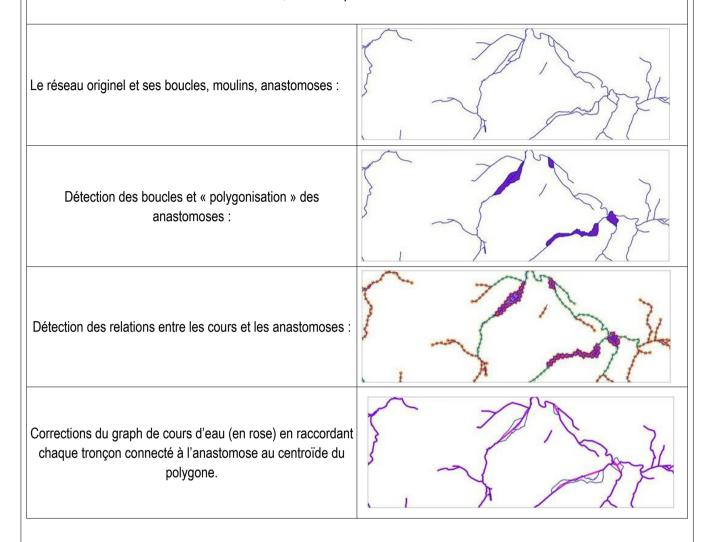
Illustration 11: Principes de fonctionnement de la fonction de correction des anastomoses
