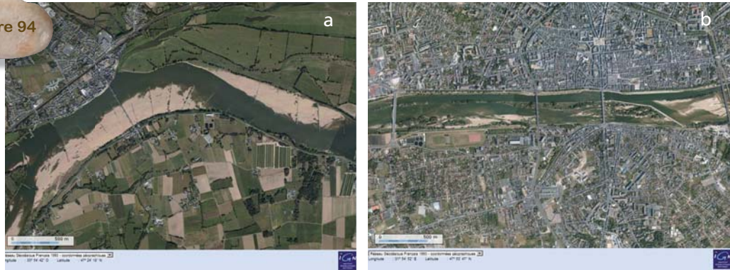
(a) épîs de navigation (ouvrages perpendiculaires à l'écoulement) sur la Loire à Ingrandes, (b) Dhuis et chevrettes (ouvrages de navigation plus ou moins parallèles à l'écoulement) sur la Loire à Orléans.
