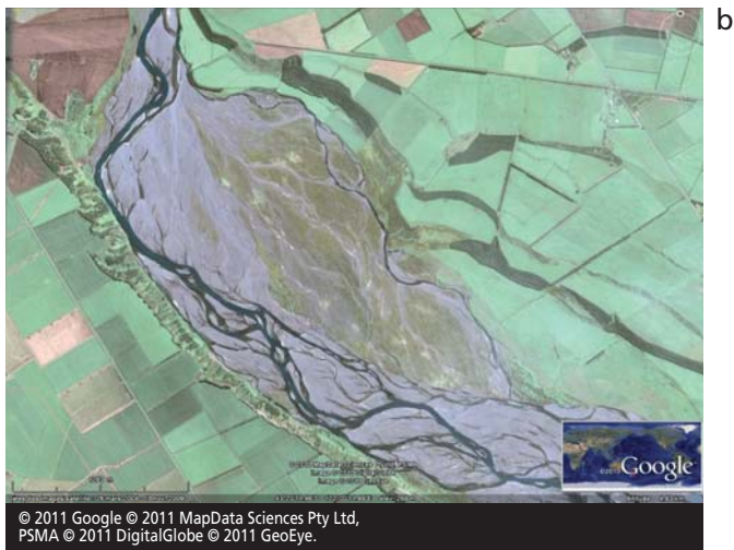
Exemples de stockage naturel des alluvions grossières en transit (bancs de convexité, zones d'élargissement brutal, portion végétalisées des lits en tresses, etc.).
