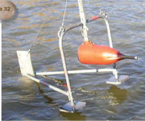
Bouteille de Delft sur chariot pour la mesure du transport solide à proximité du fond.
