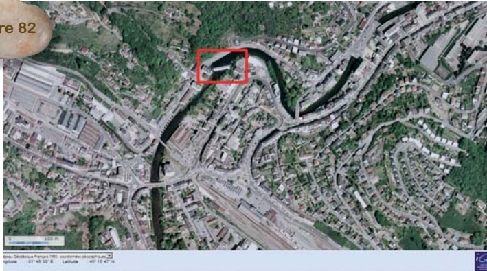
Exemple d'absence d'alluvions visibles en aval d'un seuil (seuil de Souilhac à Tulle présenté plus haut).
