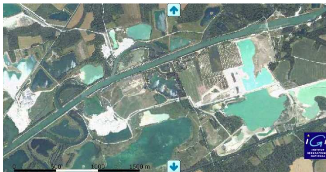
Figure 5 : Exemple de rescindements de méandres à vocation de navigation sur la Seine (Géoportail, IGN)
