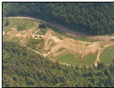
Figure 4 : Renaturation du Haut-Dugeon : de gauche à droite, le chenal rectiligne et incisé en 1996 ; vue aérienne des travaux ; lit restauré méandriforme et connecté à sa zone humide en 2000, 3 ans après les travaux
