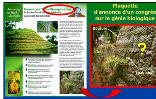
Figure 10 : Tirée d'une plaquette d'annonce d'un grand congrès sur le génie végétal, on découvre quelques illustrations confuses telles que des gabions remplis de cailloux avec, en prime, quelques boutures insérées dedans ! Le végétal n'a aucune chance de survie et il n'est utilisé que comme décoration de systèmes lourds et stériles pour faire croire que l'ouvrage est vivant.
