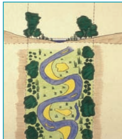
Le reméandrage consiste à redonner au cours d'eau la possibilité de trouver son équilibre naturel entre la sédimentation et l'érosion.
