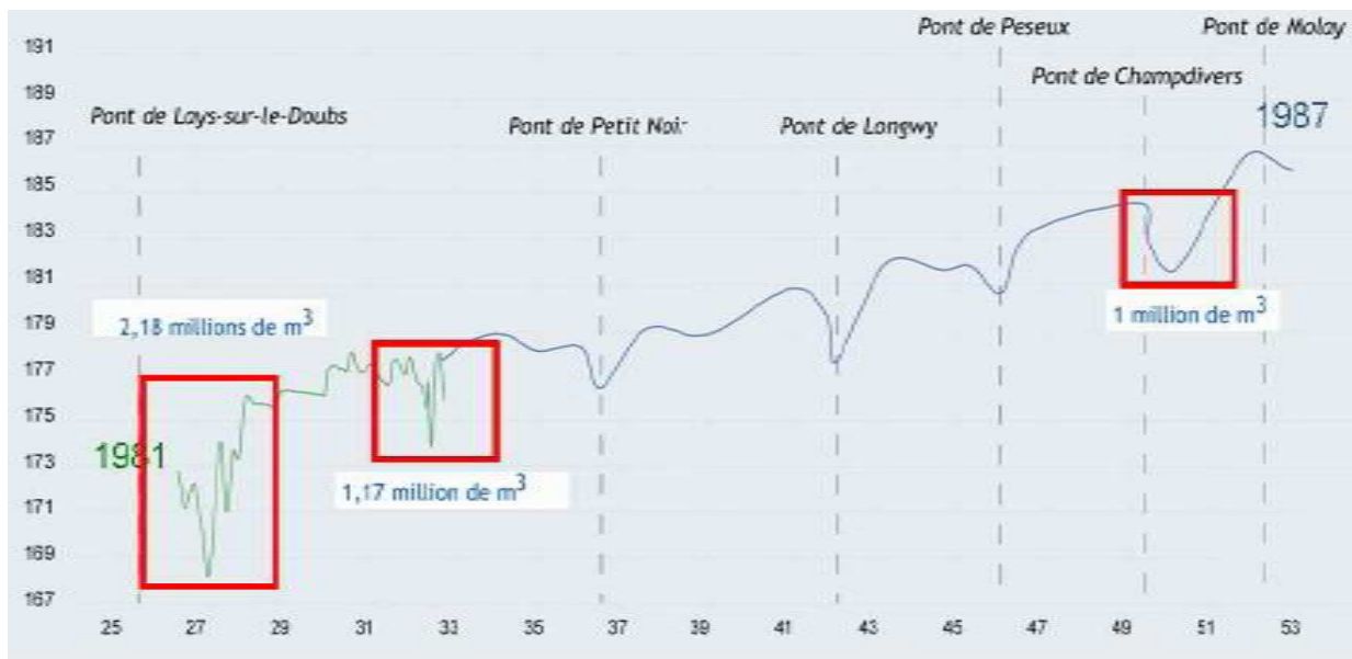
Figure 10 : Exemple de profil en long sur le Doubs (source Rollet et Piégay, 2005)
