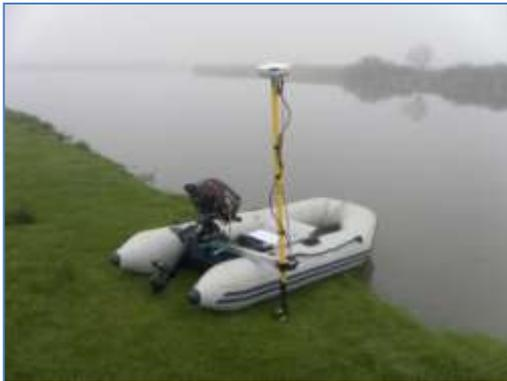
*Vue de l'embarcation motorisée équipée de son sondeur.*
