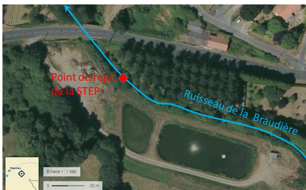
Illustration 8 : Exemple de la STEP de Tillières (lagunage oxygéné), localisation du point de rejet dans le ruisseau de la Braudière.
