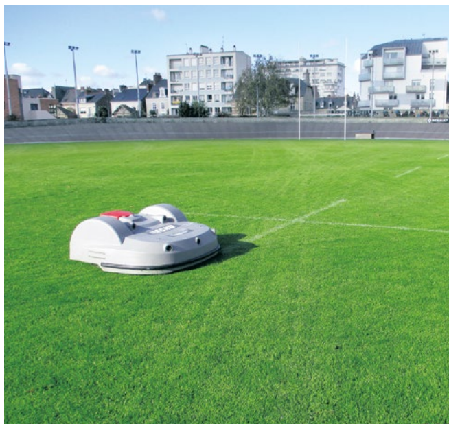
Depuis septembre 2019, la tonte sur le terrain de rugby Bougouin est assurée par un robot. Les résultats sont jugés concluants, sous réserve que le robot de tonte puisse accomplir un quota d'heures journalier suffisant. © P. LOUEDEC, Ville de Rennes
