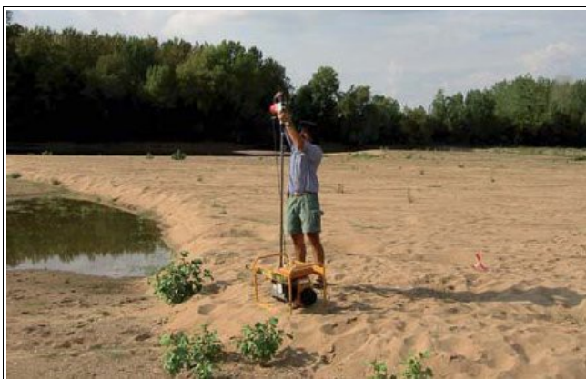
Ill. 63: Mise en place d'une chaîne d'érosion © J-R Malavoi
